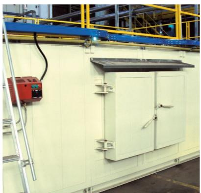
pour préchauffer les moules et faire des traitements thermiques sur des équipements comme les goulottes, les moules ou autre.
